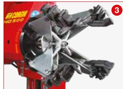
Einspannklauen der Spitzenklasse. Einspannung **von 14 bis 26 Zoll**. Maximale Leistung dank der 7 verschiedenen verfügbaren Einspannmethoden. **Min. Einspanndurchmesser: 100 mm**. Im Lieferumfang sind Felgenanlegetopfen aus Kunststoff in verschiedenen Stärken für eine perfekte Felgensicherung vorhanden.
