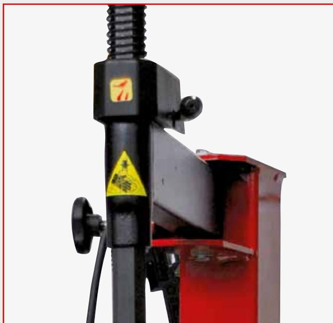
*O **posicionamento horizontal** da ferramenta é obtido por intermedio de um volante roscado. A regulação inicial permanece inalterada quando se trabalha com varias rodas das mesmas dimensoes. **Basta accionar uma alavanca** para obter a subida da ferramenta relativamente a jante e o bloqueio vertical do veio.*
